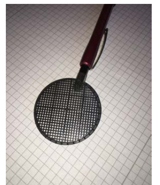
Füllkörper in Kaldnes-Becken
